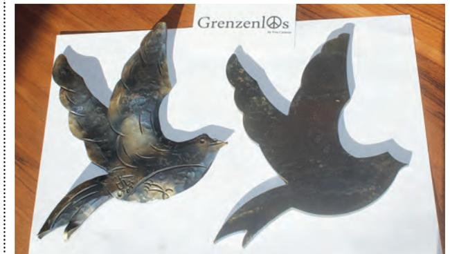
Die Friedenstauben: links in fertigem Zustand, rechts der Rohling.
