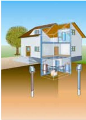
Abb. 5: Grundwasser als Wärmequelle für eine Wärmenutzungsanlage auf hohem Temperaturniveau.
