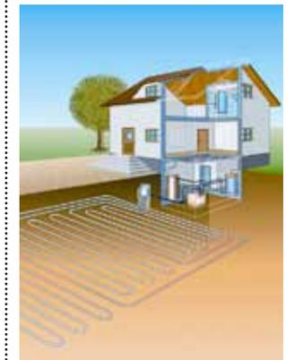
Abb. 3: Erdwärmekollektor als Horizontal-Wärmeaustauscher für den Niedrigtemperaturbedarf der Wärmenutzungsanlage.
