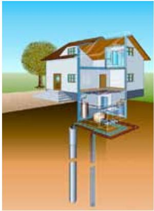
Abb. 4: Erdwärmekollektor als Erdsonde für den Bedarf im höheren Temperaturbereich der Wärmenutzungsanlage.
