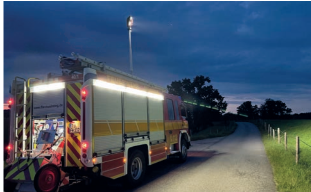
LED-Beleuchtung ermöglicht eine deutlich höhere Lichtausbeute.
