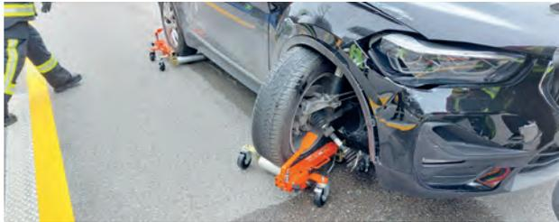
**Mit den PKW-Verlegern kann dieser von der linken Fahrbahn auf den Seitenstreifen verlegt werden.**
