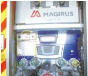
Der Pumpenbedienstand des Löschfahrzeugs.
