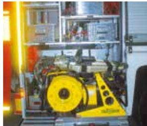
Hydraulischer Rettungssatz des Hilfeleistungslöschfahrzeugs.
