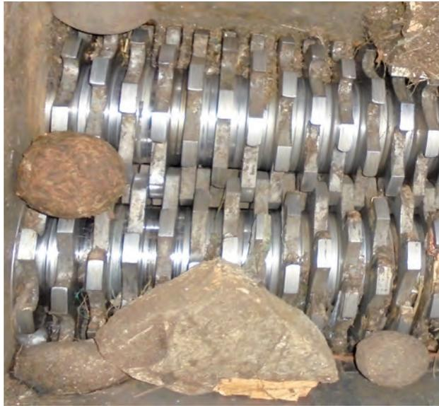
**Können die Verarbeitung in Quarzbichl (hier bei der Zerkleinerung) beschädigen: Steine im Bioabfall.**
