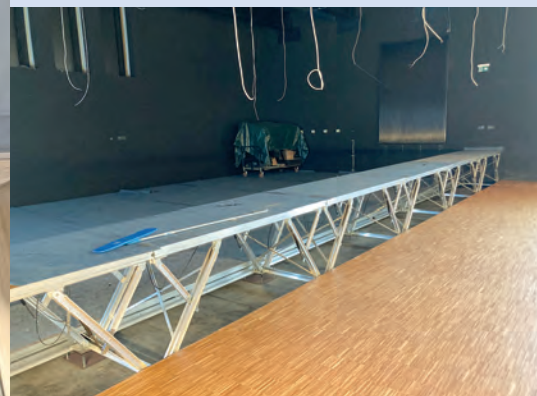
Erste Bühnenreihe in ausgefahrenem Zustand.
