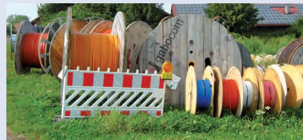
Bereit, verlegt zu werden: Glasfaserkabel für den Breitbandanschluss.
